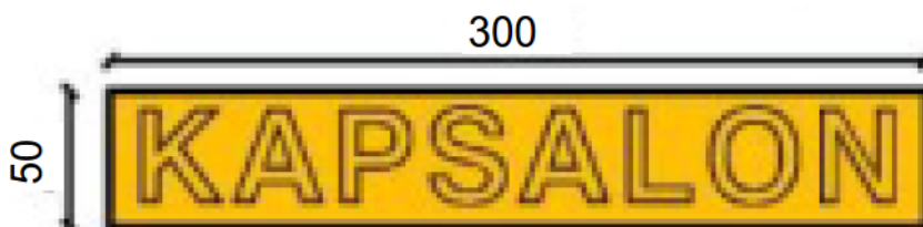
RECLAMEBORD IN HET GEVELVLAK (ONVERLICHT)
